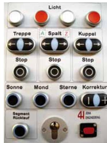
Das neue Bedientableau an der Säule des Fernrohres
