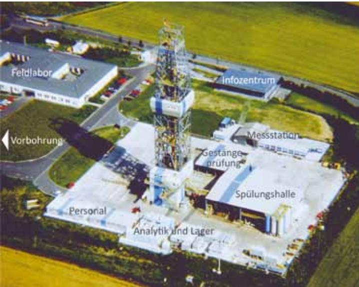
Der Bohrplatz der KTB-Hauptbohrung im Jahr 1992.
