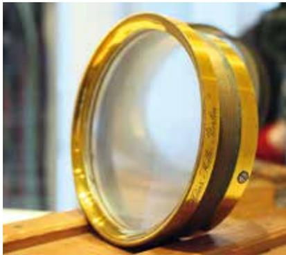
1905 kam das Objektiv in einer cirka 19 Meter langen Horizontalkamera zum Einsatz. Zur Fokussierung des Sonnenbildes war es in einer zylindrischen Führung verschiebbar angeordnet. Das Sonnenlicht wurde über ein System mit zwei Spiegeln – einen Heliostaten – in die Horizontalkamera gelenkt. Im Brennpunkt gelangte das Sonnenlicht dann in eine Filmkassette auf Glasplatten. Diese Glasplatten mussten mit ihrer jeweiligen
