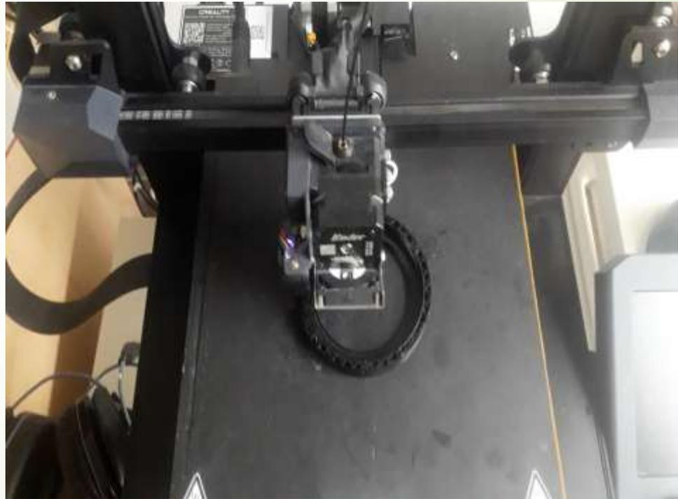
Druck einer Objektivfilterfassung
