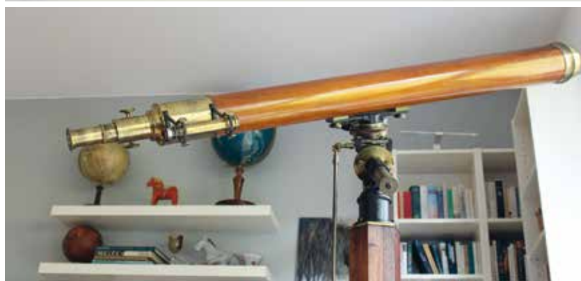
Unser WFS-Refraktor mit Mahagonitubus, Objektiv nach Fraunhofer und Messing-Okularauszug. Baujahr ca. 1890
