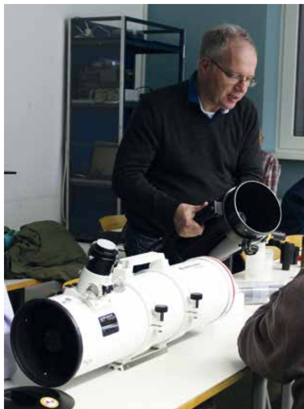
Herr Kiehl erläutert die Bauteile eines Newton-Teleskops. Der Okularauszug sollte stabil konstruiert sein, um auch schwerere Kameras sicher und verkippungsfrei zu halten. Eine Untersetzung oder ein Motorfokus erleichtern das Fokussieren.
