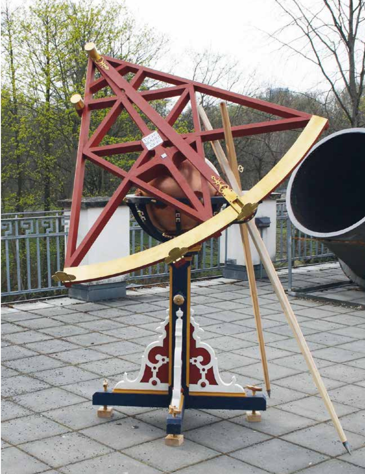
Der fertige Sextantennachbau auf der Dachterrasse der Archenhold-Sternwarte.
